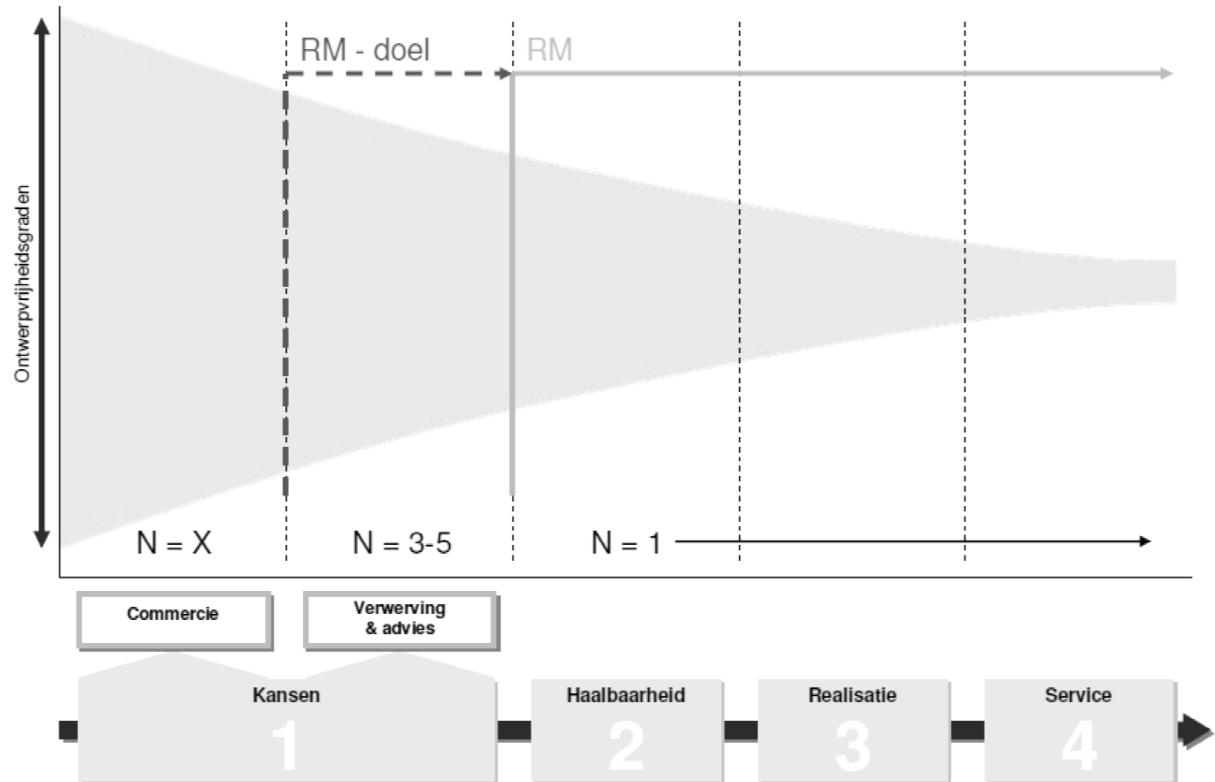
**Figuur 1:** Het aantal teams per project fase en de ontwikkelingsvrijheidsgraden in de loop van het proces
